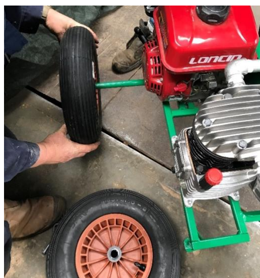
ETAPE 8 : Ajouter les roues et les fixer avec les goupilles.
