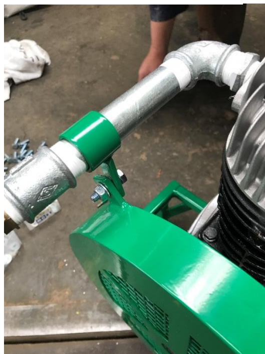
ETAPE 7 : Fixer les 3 points du couvercle de protection de la courroie.
