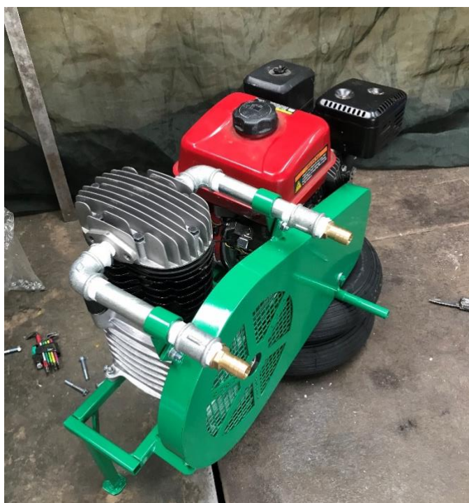
ETAPE 8 : Ajouter les roues et les fixer avec les goupilles.
