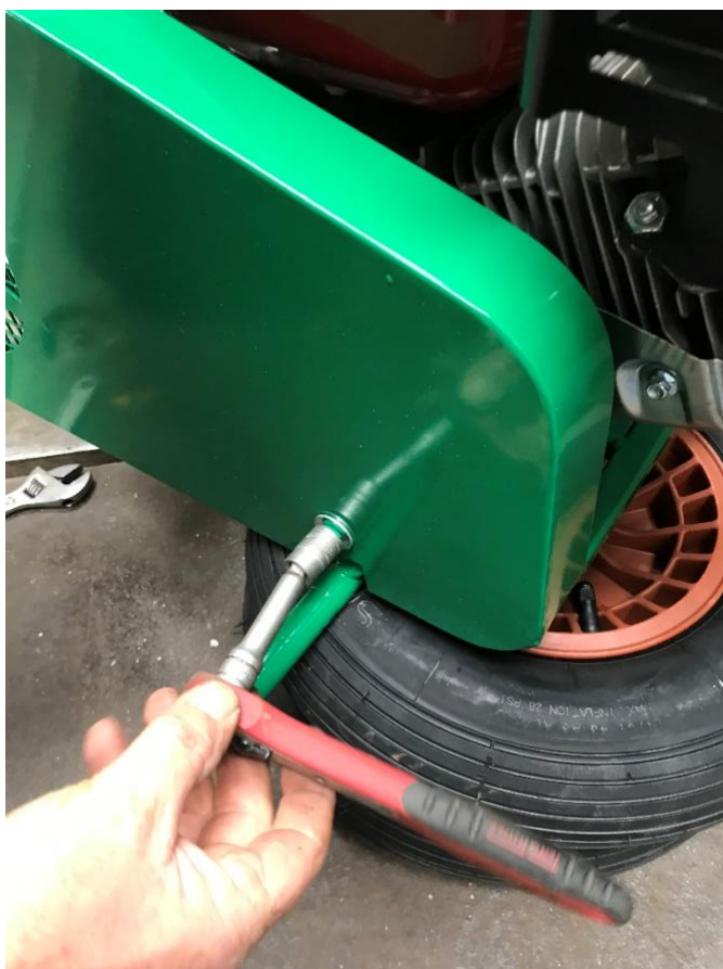
ETAPE 7 : Fixer les 3 points du couvercle de protection de la courroie.
